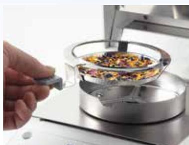
2. Добавьте и равномерно распределите пробу.
