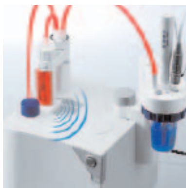
Данные автоматически считываются с радиочастотной метки (RFID-метки), с бюретки или электрода Plug & Play
