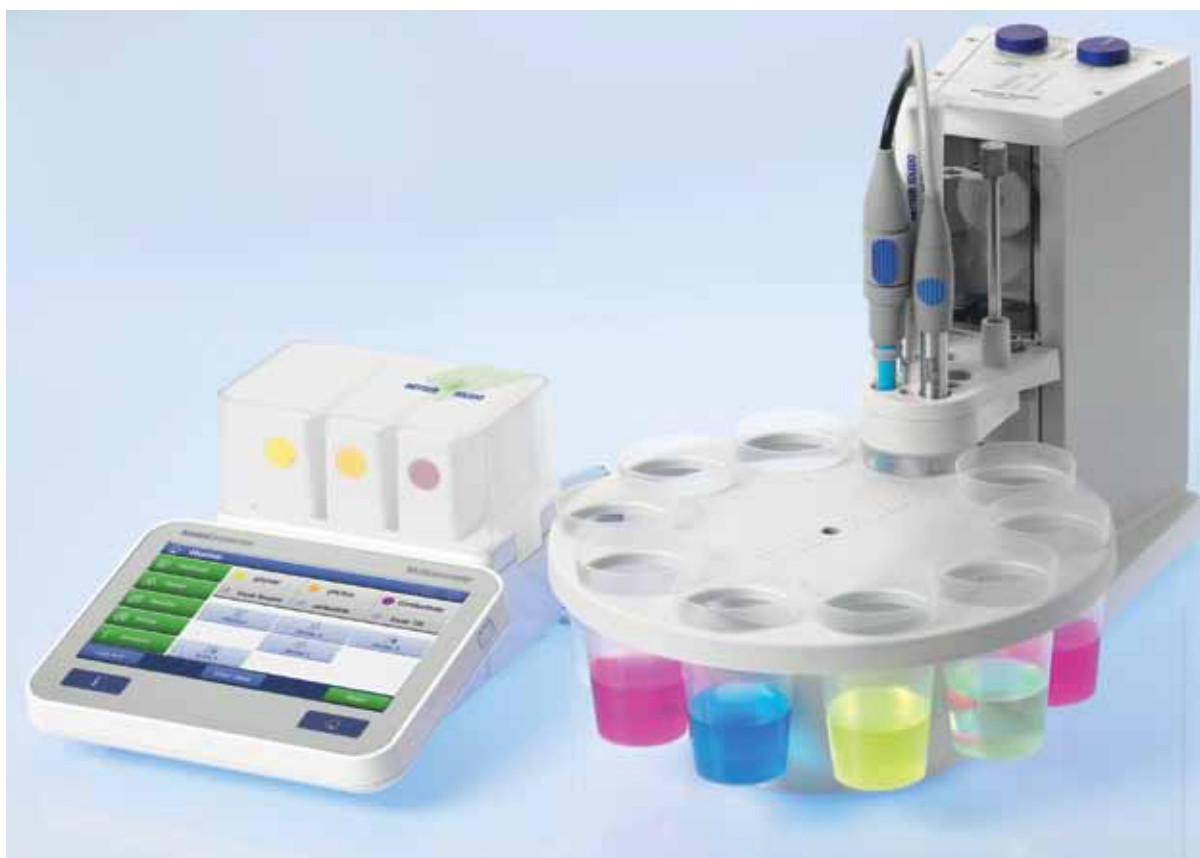
Измеритель S475 в комплекте с электродами и автоподатчиком образцов Rondolino
