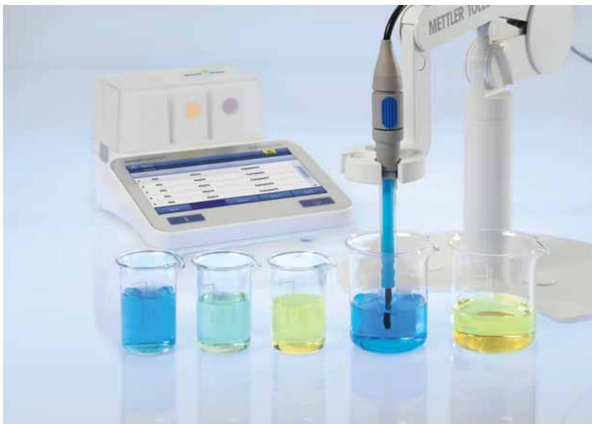
Измерение серии образцов с помощью SevenExcellence; штатив uPlace для удобной работы (входит в комплект поставки прибора)
